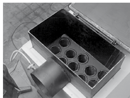
Bild av tubkonvektionsdel med sotningslucka
